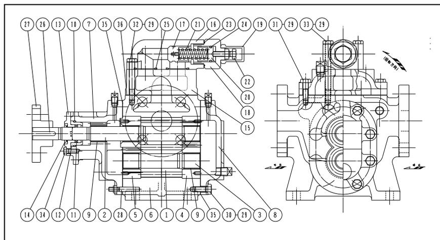
本ポンプは、ケーシング内に軸受けで支えられた1組の歯車と軸により、吸込側でそれぞれの歯車の歯形に液を含み、これが回転する事によりケーシング内側を回って連続的に送り出されるものです。軸受けはDUブッシュを採用し、自己潤滑液により、潤滑及び冷却されます。吐出側に設けた給油孔から軸受けの油溝に送り込まれ、軸受けを潤滑した液は吸込側へ戻されています。
